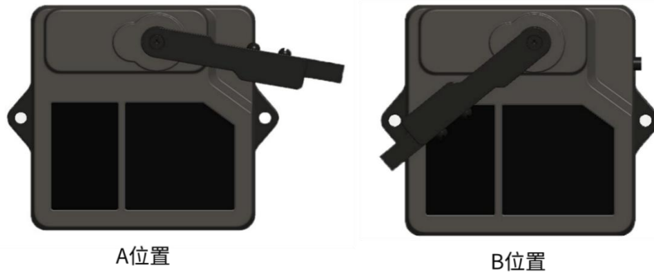
图 4-1 TF02-Pro-W 除尘刷运动起始位置示意
