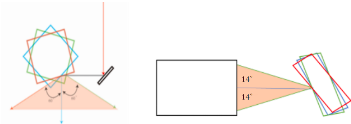
图 1 扫描机构示意图
